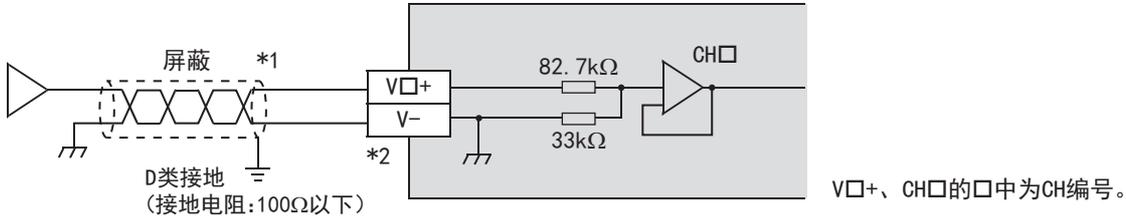
\*1 模拟量输入线使用双芯的带屏蔽双绞线电缆，且接线时请与其他动力线或容易受电感影响的线隔离。
