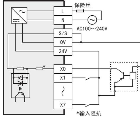
输入模块(扩展连接器型)、输入输出模块(扩展连接器型)时
