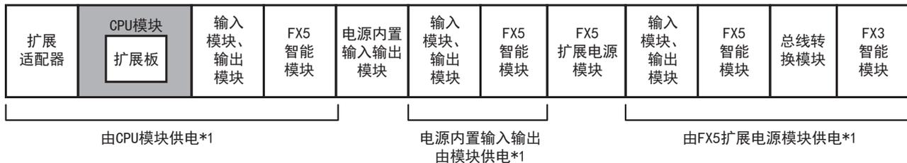
\*1 输入模块的输入回路由DC24V供给电源或外部电源供电。但是，DC电源型中没有DC24V供给电源。
