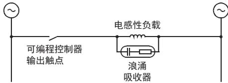
浪涌吸收器的额定电压请选择适合所用输出的产品。其他规格请参考下述内容。
