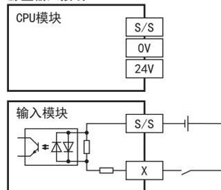
• 电源内置输入输出模块使用外部电源时
