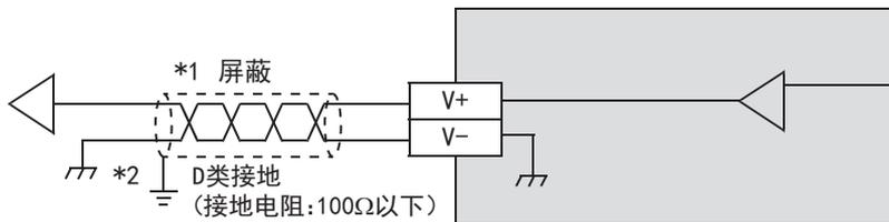
\*1 模拟量输出线使用双芯的带屏蔽双绞线电缆，且接线时请与其他动力线或容易受电感影响的线隔离。
