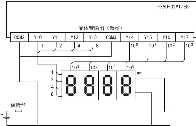
用于漏型接线的7段码显示
