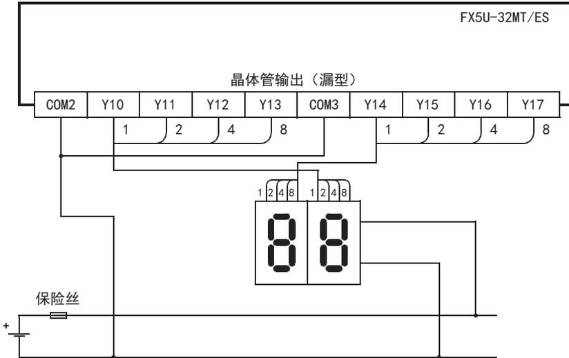
用于漏型接线的7段码显示
