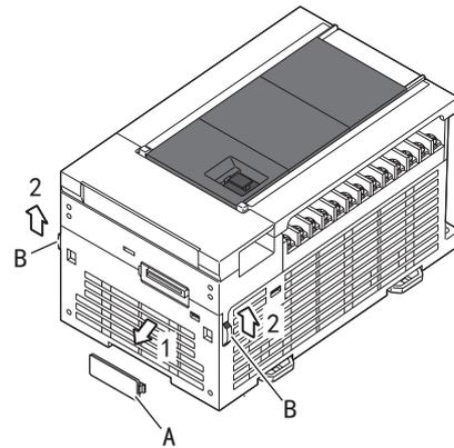
3. 如右图所示，将扩展适配器连接到CPU模块上。
