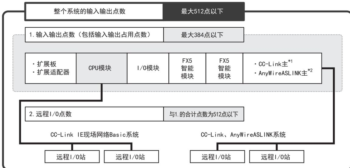
\*1 使用FX3U-16CCL-M主站时需要总线转换模块。
