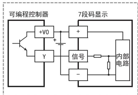
\*1 请使用带闭锁且内置BCD解码器的7段码。
