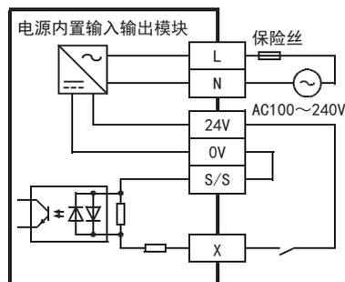
• 输入模块、输入输出模块、高速脉冲输入输出模块使用外部电源时
