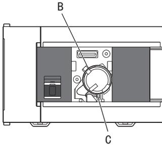
6. 安装新电池。（☞ 154页 电池的安装）
