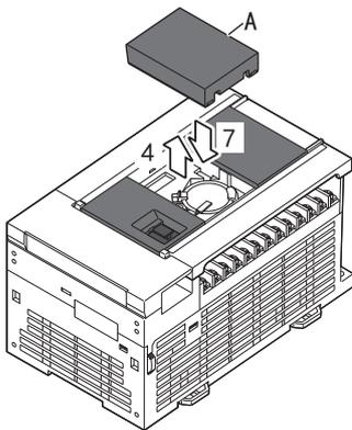
5. 将旧电池从电池座（下图B）拆下，然后拔出电池用连接器（下图C）。
