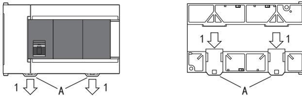
2. 将DIN导轨安装槽的上侧（下图B）对准DIN导轨后挂上。
