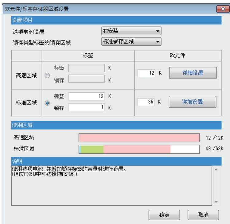
在软件/标签存储器区域设置画面，请将选项电池设置设定为“有安装”。
