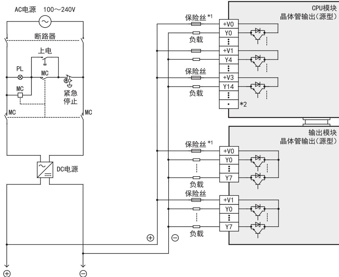
连接到可编程控制器输出端子的负载电源
