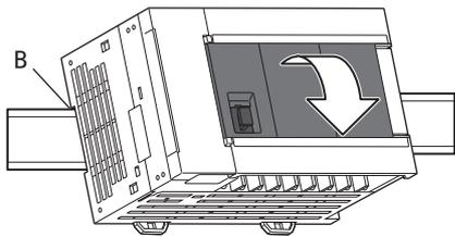
3. 将产品按压到DIN导轨上，在此状态下锁住DIN导轨安装用卡扣（下图C）。
