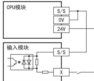
• 电源内置输入输出模块使用DC24V供电电源时
