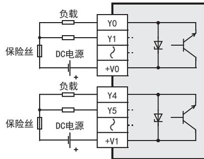
输出模块（扩展连接器型）、输入输出模块（扩展连接器型）时，晶体管输出型产品包括8点公共端输出型的产品。
