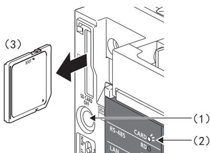
1. 按住SD存储卡使用停止开关（1）1秒以上，将SD存储卡设为访问停止状态。访问停止处理过程中CARD LED（2）闪烁，处理结束后灯灭。
