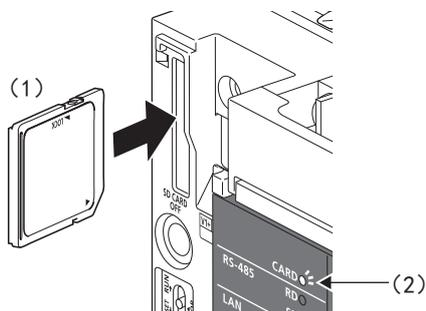
1. 将SD存储卡（1）的凹口朝下，笔直地插入SD存储卡槽。安装后，确认有无浮起。安装不充分时，可能因接触不良导致误动作。
