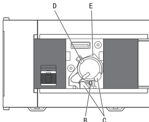
5. 安装连接扩展板用的连接器盖板。根据步骤2拆下扩展板后，请再次安装产品。
